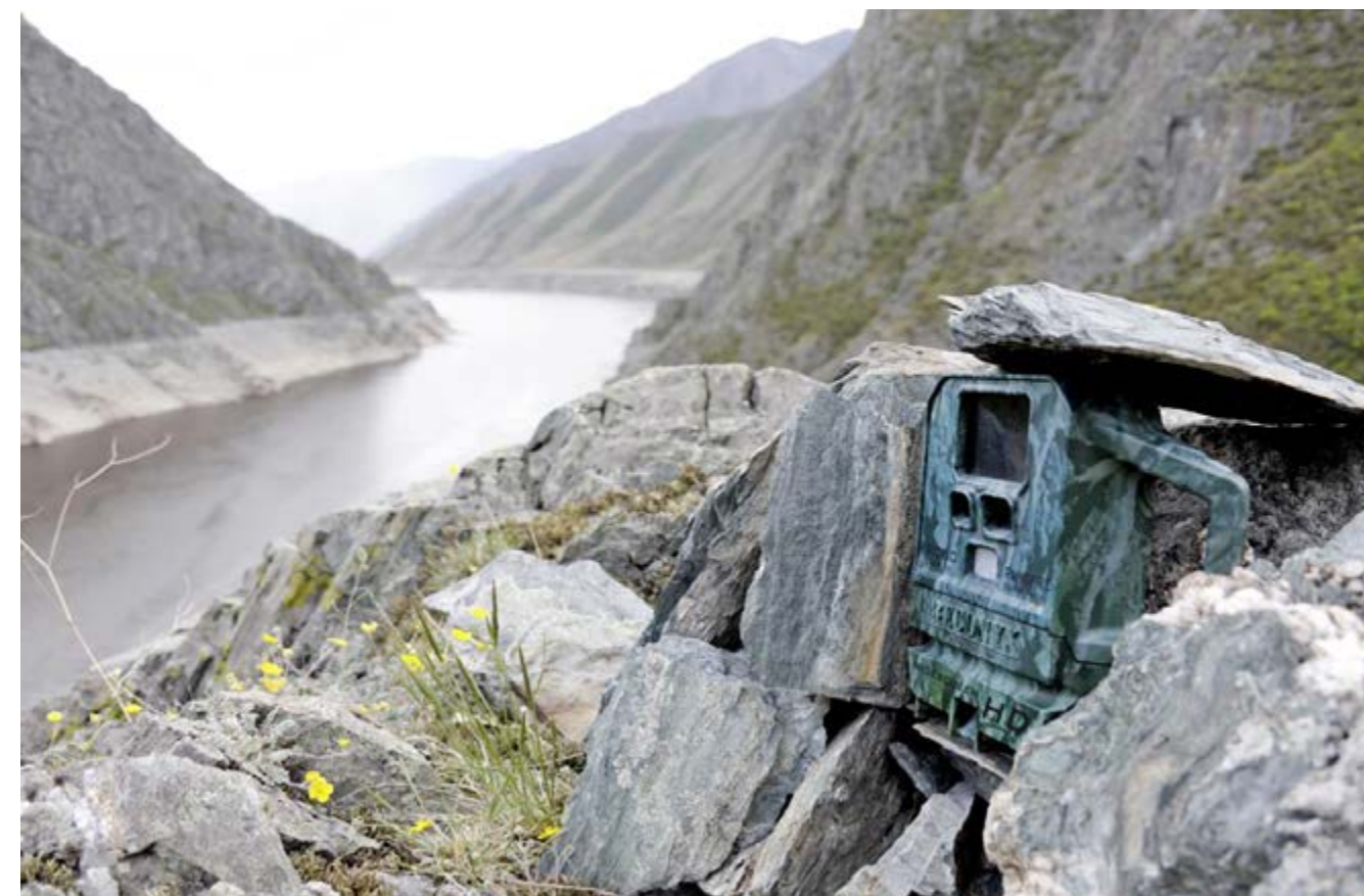
Способ установки автоматического фоторегистратора в безлесной зоне
