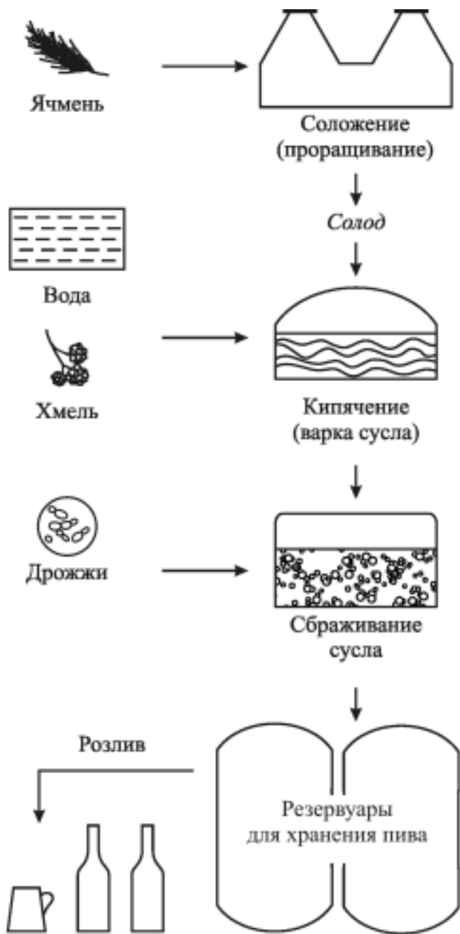
Рис. 51. Технологическая схема приготовления пива.
